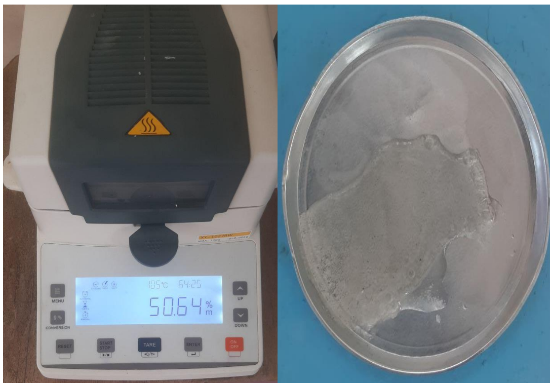
1-расм. а) Учувчан моддаларни аниқлаш қурулмаси. ДЭГ нинг тузли қолдиги.
