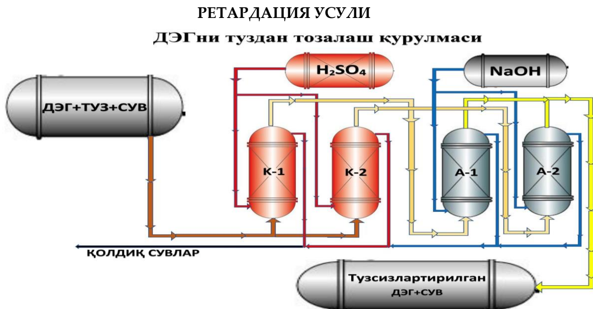
2-расм. ДЭГ ни туздан тозалаш қурилмасини чизма схемаси.
