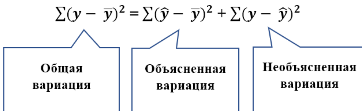
Рис.4. Разложение дисперсии зависимой переменной на сумму объясненной с помощью регрессионной модели дисперсии и необъясненной дисперсии.
